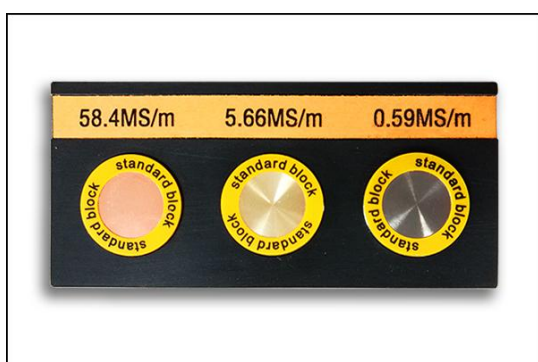
3.校准标块 (A 型带 3 块，A1 型带 2 块)
